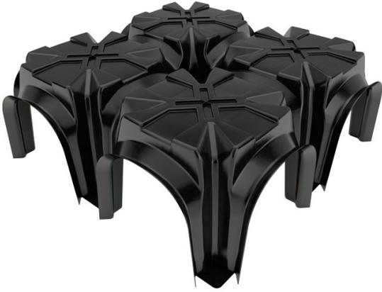
Multimodulo se origina de la experiencia de Geoplast en la producción de encofrados perdidos para la construcción de forjados sanitarios ventilados: este elemento une cuatro elementos Modulo en un único elemento, proporcionando altos estándares de capacidad de carga tanto durante la instalación como durante el hormigonado gracias a nueve soportes por cada elemento..
